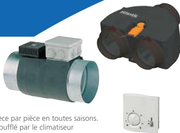
Les systèmes VERSO et VERSO BYS permettent de réguler la température pièce par pièce en toutes saisons. Les registres motorisés détectent automatiquement la température de l'air soufflé par le climatiseur et la compare à la température de consigne du thermostat situé dans la pièce. Ils s'ouvrent ou se ferment pour ajuster le débit d'air afin d'assurer le confort souhaité.
